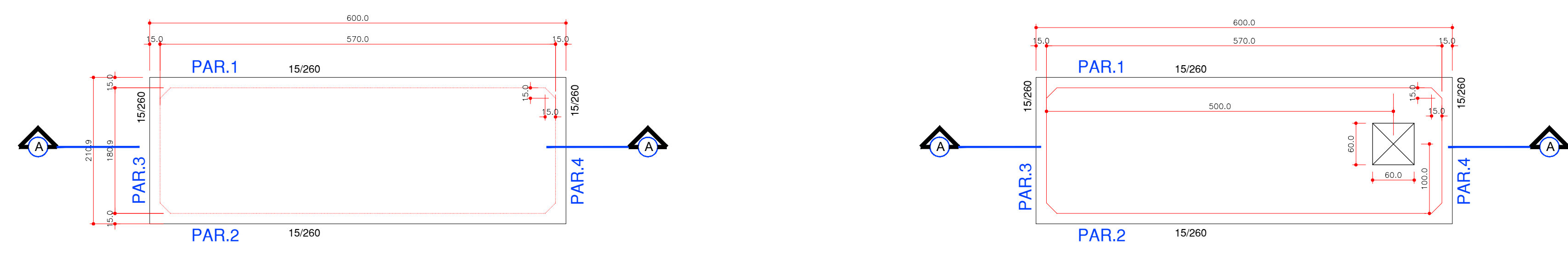
FORMA - FUNDO DA CISTERNA ESC. 1/50
