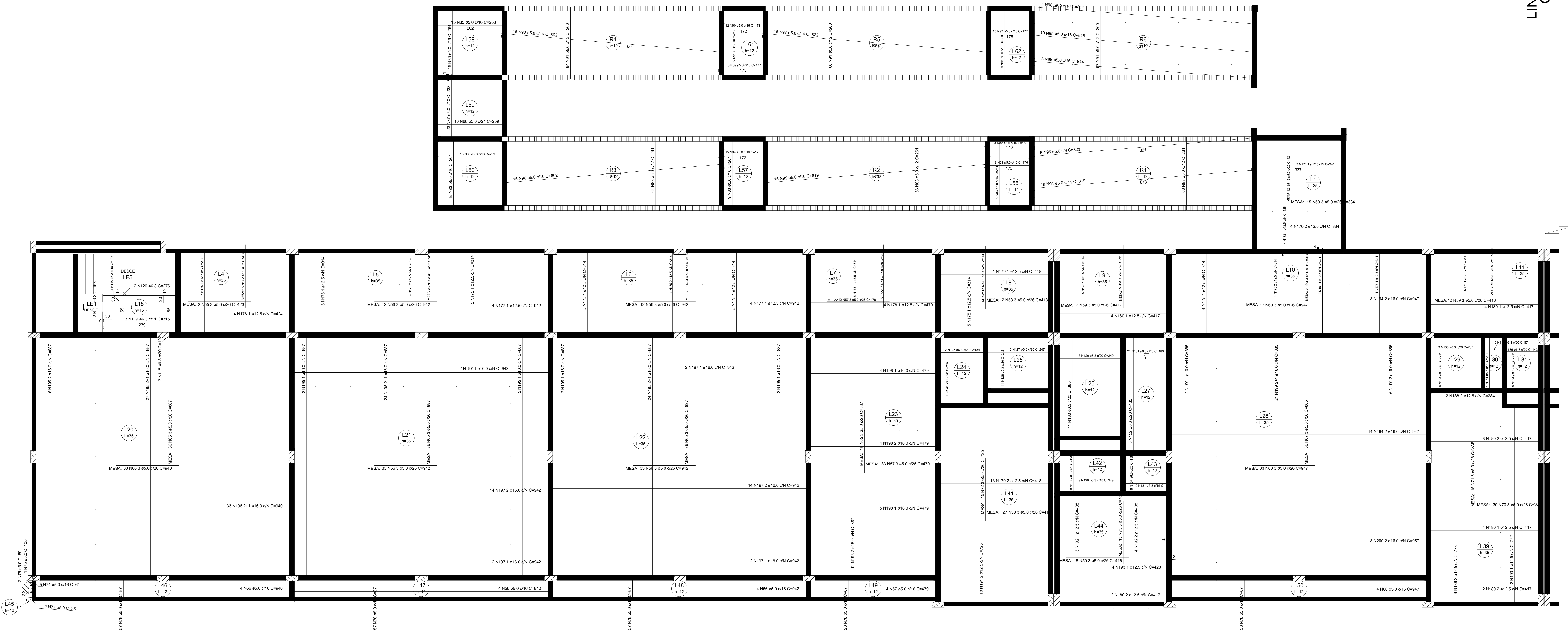
Armação positiva das lajes do pavimento superior escala 1:50
