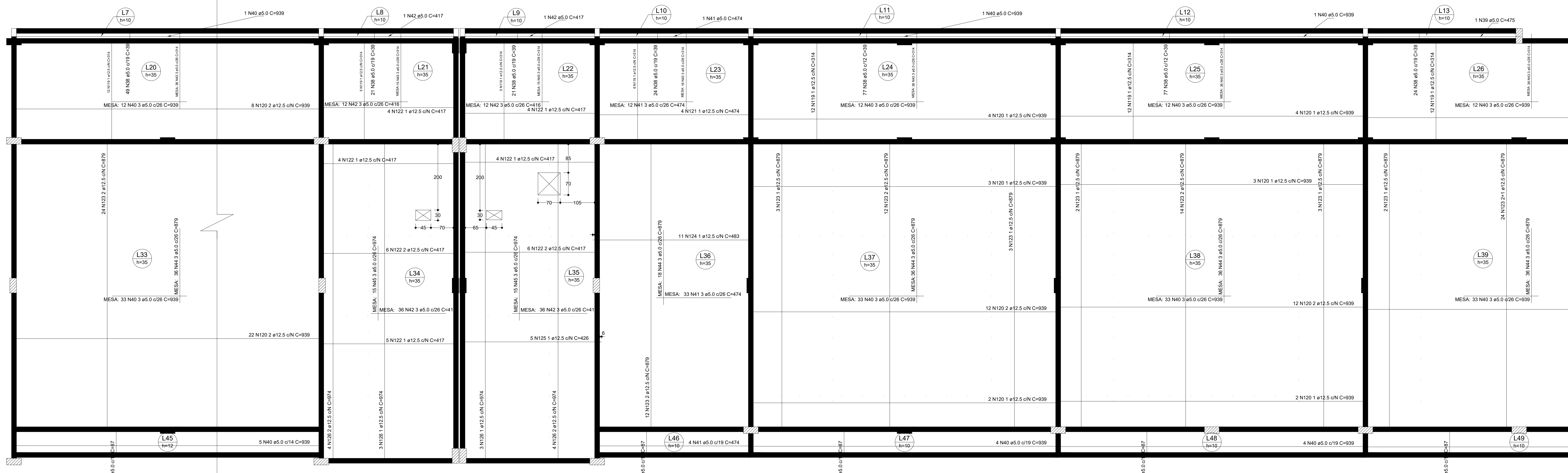
Armação positiva das lajes do pavimento Cobertura escala 1:50
