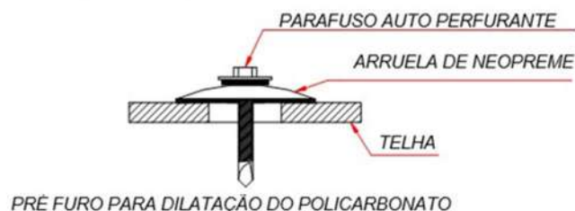
Figura 4: Exemplo de fixação (se o parafuso tem 6 mm de diâmetro, o furo deverá de no mínimo 8 mm a 10 mm e arruela com gaxeta)
