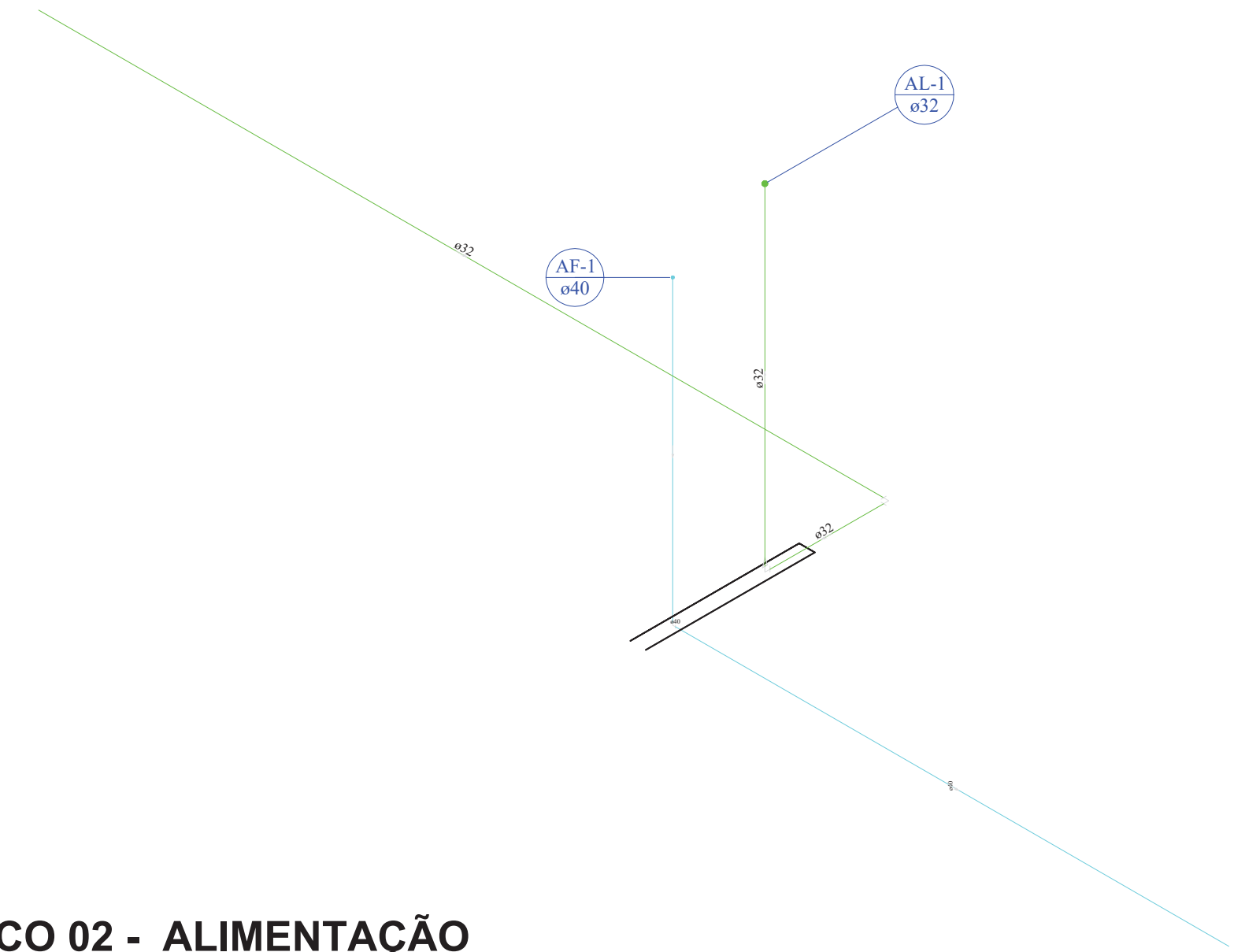
ISOMÉTRICO 02 - ALIMENTAÇÃO PAV. TÉRREO - ARQUIVO Escala 1:20
