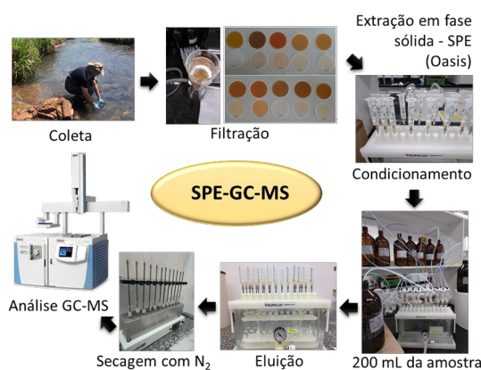
Figura 15. Processo de preparo de amostra por SPE para análise de atrazina e metabólitos em água superficial por GC-MS
