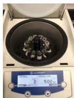
Utilizando o concentrador de amostras para a troca de solvente de extração para o solvente de eluição/injeção
