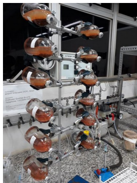
Reatores anaeróbicos montado no laboratório da UNIFAL
